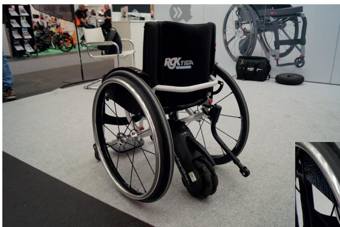
Der „SmartDrive“ von der Firma Max-Mobility [www.maxmobility.de](http://www.maxmobility.de) nimmt die Schwunggeschwindigkeit auf und übernimmt dann mittels Elektromotor die Arbeit. Ideal für Kaufhäuser.
