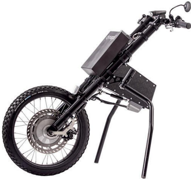
Dank der Aluminium-Leichtbauweise und dem Elektromotor vereint das dynagil AC Fahrspaß mit größtmöglichen Komfort.
