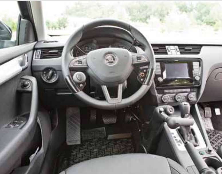
Basisausstattungen im CLUB MOBIL-Leihfahrzeug: VEIGEL-Handbediengerät für Gas und Bremse, Gaspedal rechts, elektronisches Linksgas, Lenkradknopf, Doppelpedale für Führerscheinausbildung
