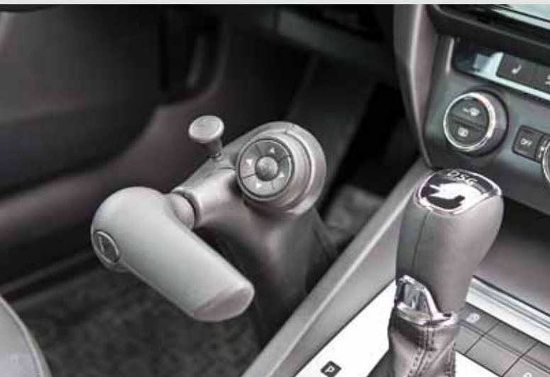
VEIGEL-Classic inkl. Commander: Handbedienung für Gas und Bremse; mit nur einem Finger können Blinker, Auf- und Abblendlicht, Scheibenwischer und Hupe betätigt werden!
